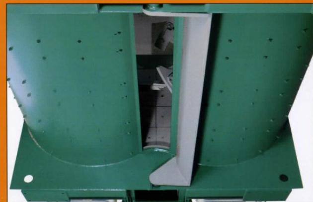
**Systemy uszczelnienia** zamontowane na osiach mieszających mają działanie kombinowane; z działaniem bariery mechanicznego uszczelnienia labiryntowego za pomocą smaru łączy się uszczelnienie za pomocą specjalnych uszczelek. Wolna przestrzeń pomiędzy systemem uszczelnień a łożyskiem wspierającym zapewnia dodatkową ochronę samemu łożysku.
